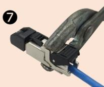
⑦ ハウジングの金属部分をプライヤーでパチンと音がするまで圧着する
