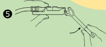
⑤ CSPTを使用してプラグハウジングに完全に挿入する
